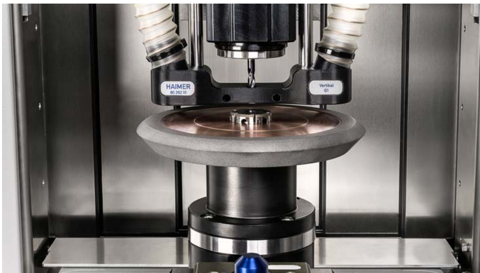
Auswuchten einer Schleifscheibe durch axiales Bohren
